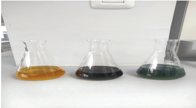
Slika 11. Promjena boje prilikom titracije otopine s Mohrovom soli. Slijeva na desno: boja otopine u početnom dijelu titracije, neposredno prije i nakon točke ekvivalencije (foto: Matan, 2023.)
