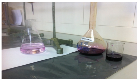
Slika 9. Pojava trajno ružičaste boje nakon titracije s 0,04 M \text{KMnO}_4 (foto: Ercegović, 2015.)
