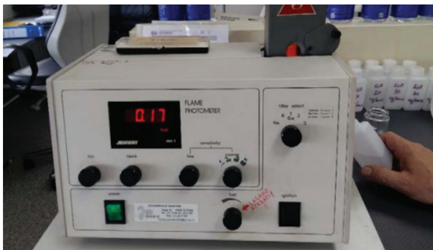
Slika 16. Očitavanje kalija na plamenfotometru (Čoga i Slunjski, 2018.)
