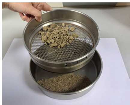
Slika 5. Sijanje tla - odvajanje skeleta od sitnice tla (foto: Bensa, 2023.)
