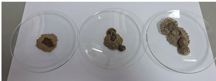
Slika 7. Kvalitativno određivanje karbonata u tlu, slijeva na desno: nekarbonatno tlo, slabo karbonatno i jako karbonatno (foto: Bensa, 2023.)
