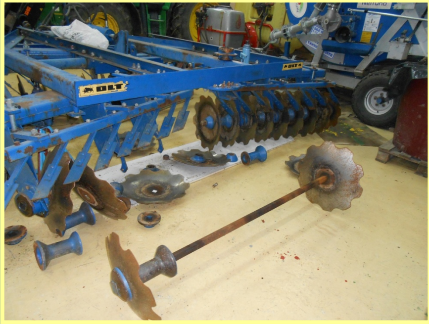
Popravak tanjurače (zamjena ležaja baterije)
